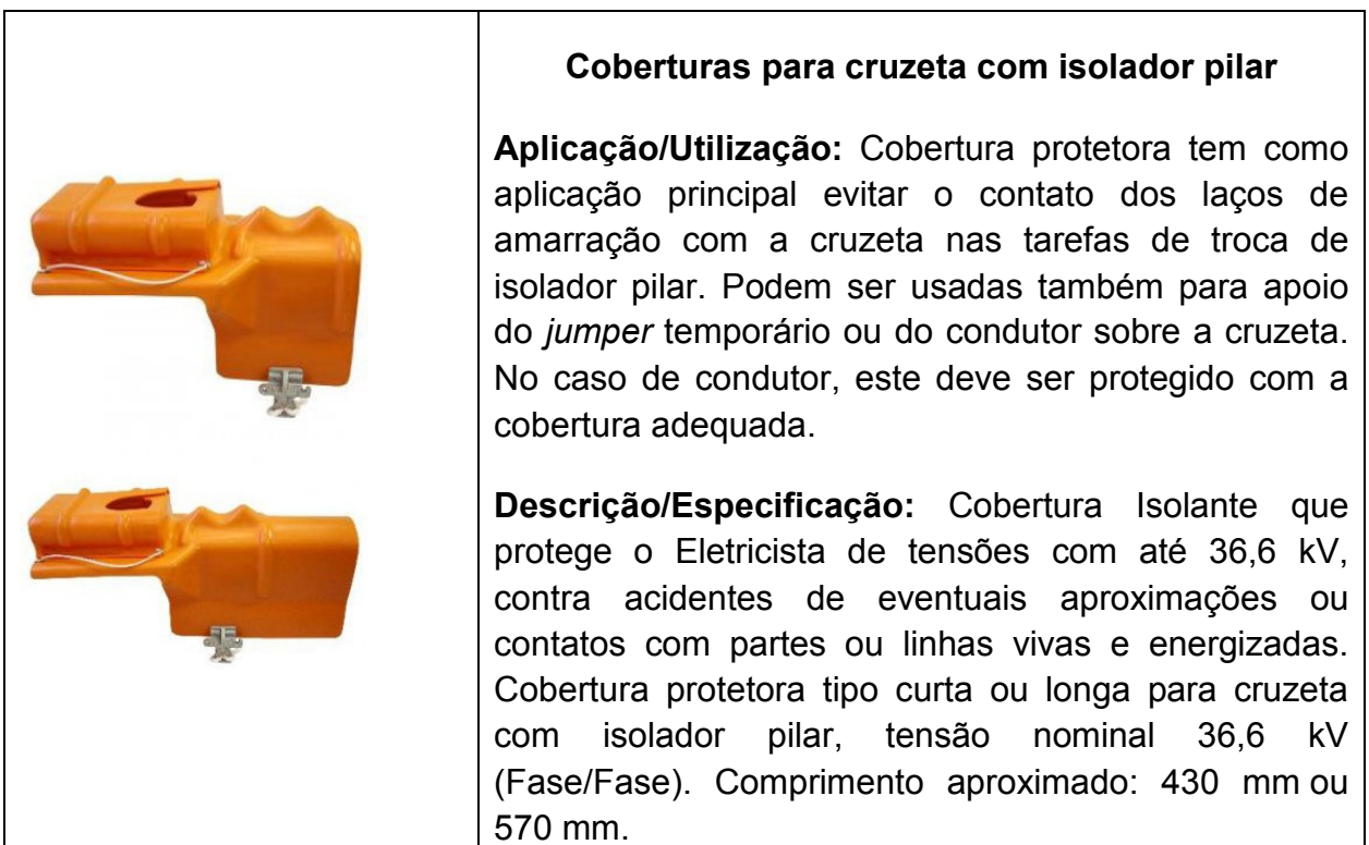
Figura 108 – Coberturas para cruzeta com isolador pilar
