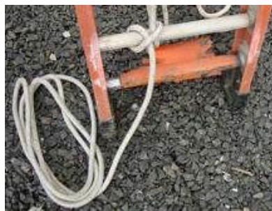
Figura 18 – Nó fiel na base da escada
