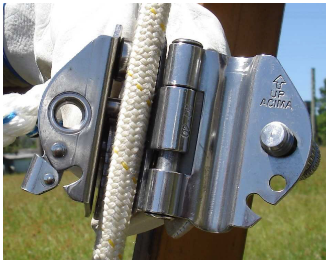
Figura 33 – Instalação do trava-quedas na linha de vida
